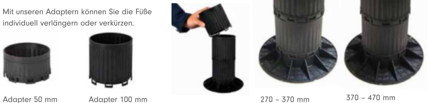
Die Anzahl der benötigten Stelzlager pro m<sup>2</sup> ist abhängig von dem Abstand der Konstruktionbalken, der Belastbarkeit vom Balken selbst und der Bausituation! Im Normalfall benötigen Sie als Faustformel 4 – 5 Füße pro m<sup>2</sup>. (siehe Statikberechnungen zu UKAL)
