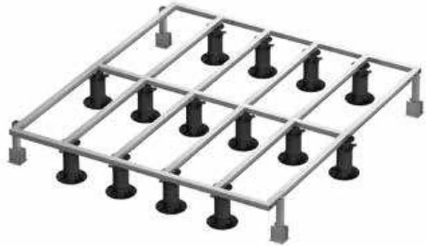
Der Tellerboden unserer Stelzlager ist durchgehend 200 mm breit – das ergibt eine großzügige Fläche von über 300 cm<sup>2</sup>! Damit wird erreicht, dass auch bei hoher Belastung und Druck, der Stellfuß nicht in den Boden einsinken kann oder sich in Folie einschneidet.
